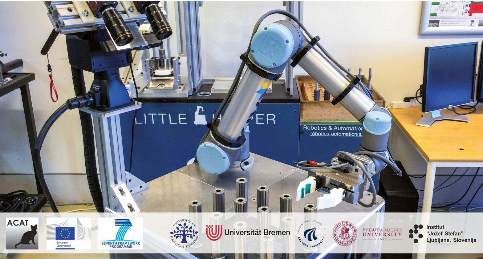
Automatisierung erfordert teure Programmierung. Das ACAT System vereinfacht dies, indem es Anweisungen für Arbeiter liest und daraus ein Roboterprogramm erstellt. Diese neuartige Art der Roboterprogrammierung kann es auch kleineren Firmen erlauben Automatisierungsanlagen anzuschaffen und ohne Expertenwissen zu betreiben.
